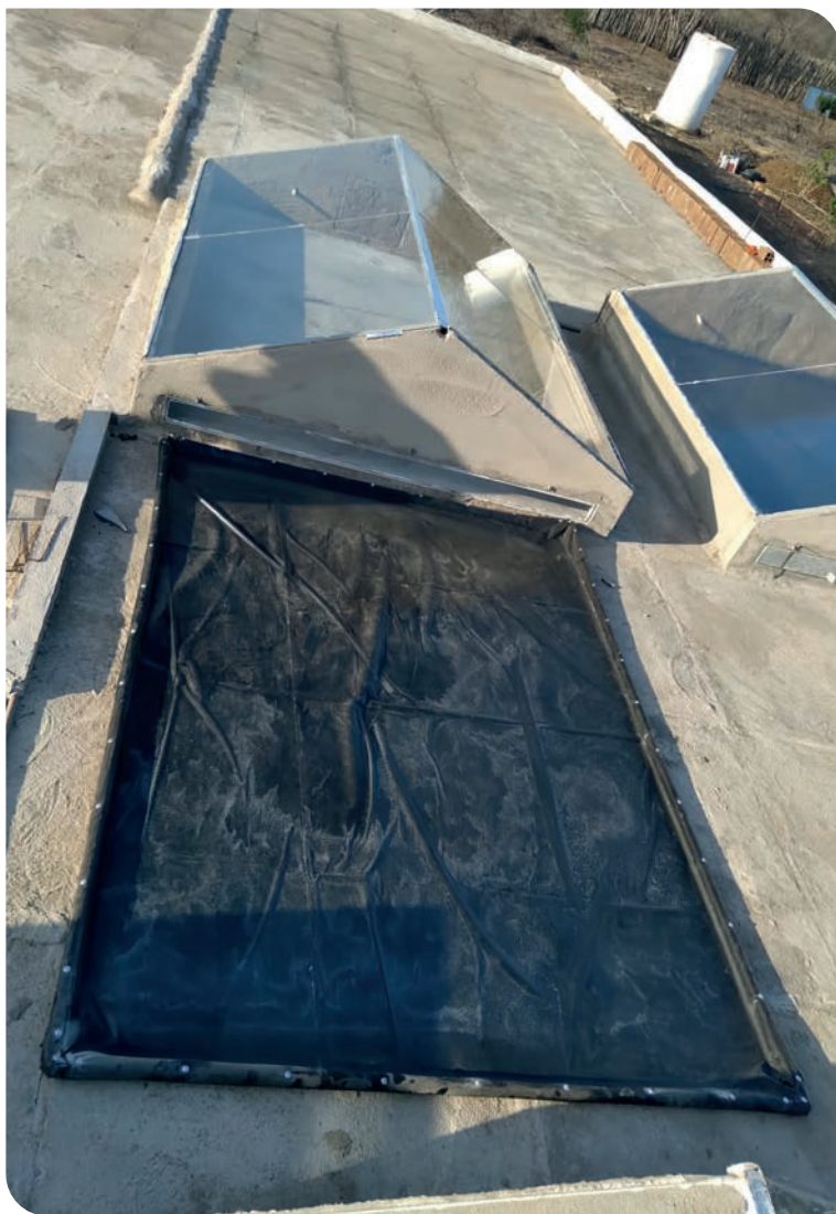
Figura 19. Dessalinizador com reservatório de água salobra.
