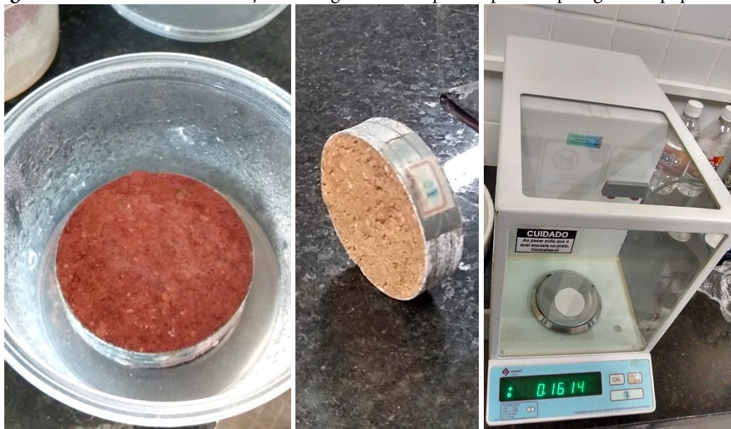
Figura 251: Processo de saturação e secagem dos corpos de prova e pesagem do papel filtro
