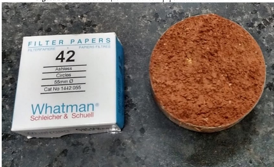
Figura 249: Ensaio de sucção matricial com papel filtro Whatman® N°42
