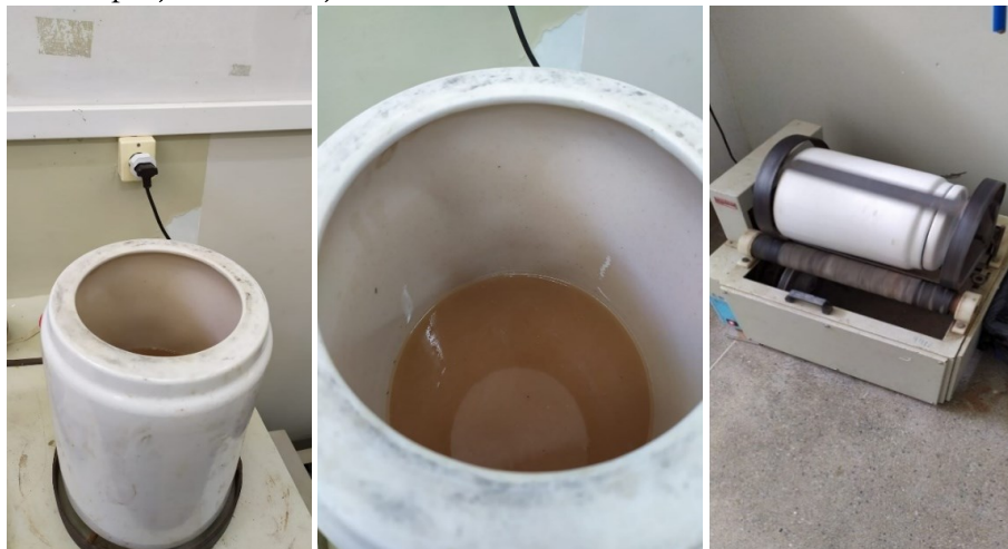
Figura 48: Adaptação na execução do ensaio de friabilidade das areias com moinho de bolas
