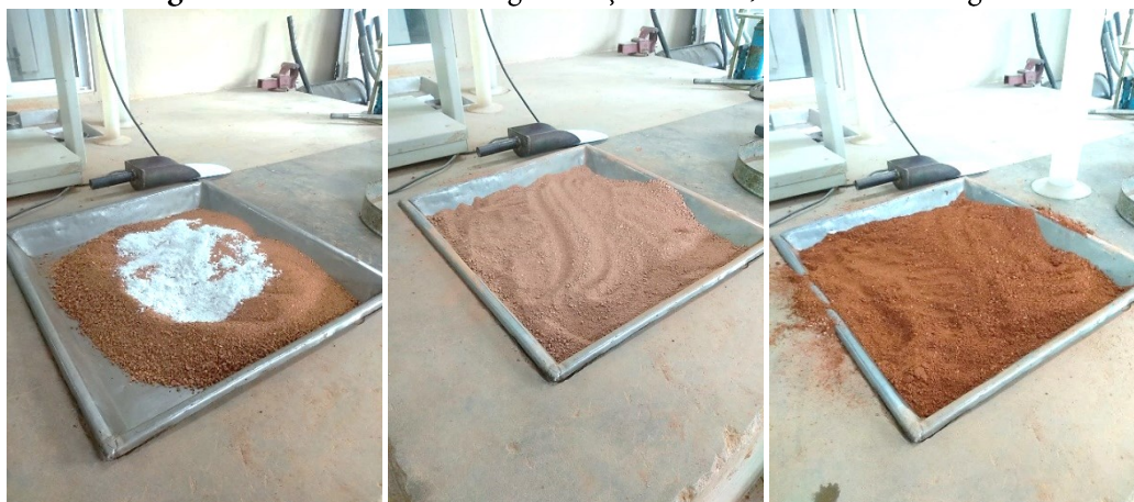
Figura 161: Mistura e homogeneização do solo, estabilizante e água
