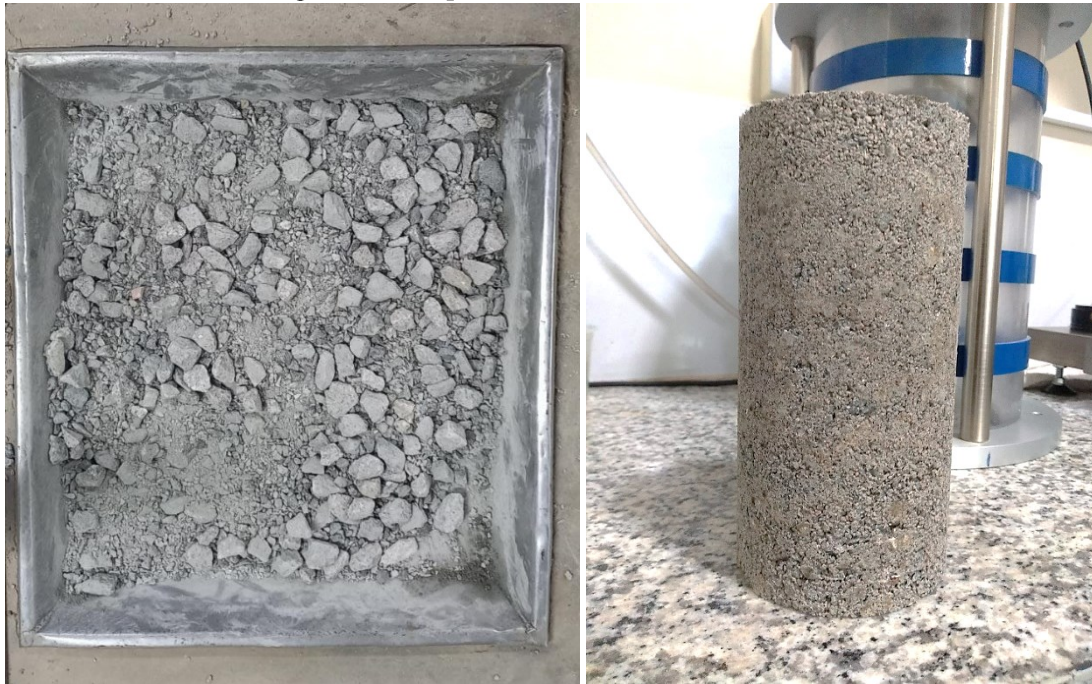
Figura 164: Aspecto visual da mistura de BGTC
