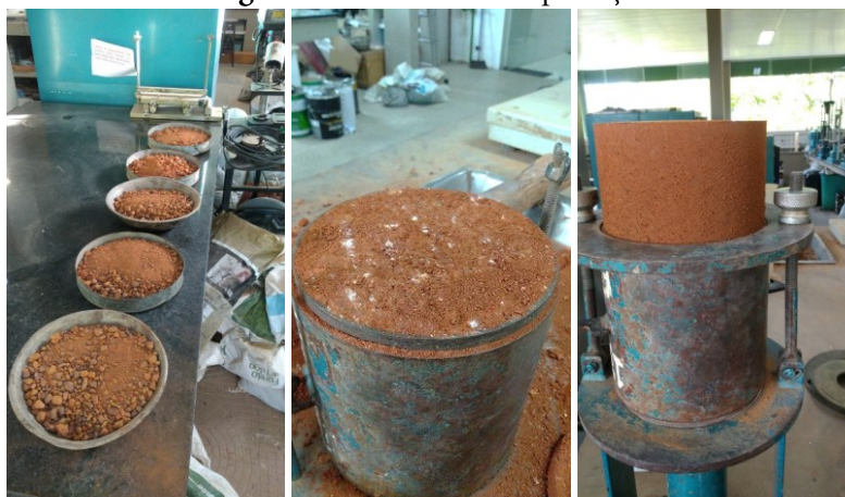
Figura 50: Ensaio de compactação
