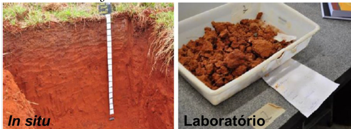
Figura 7: Macroestrutura dos solos lateríticos
