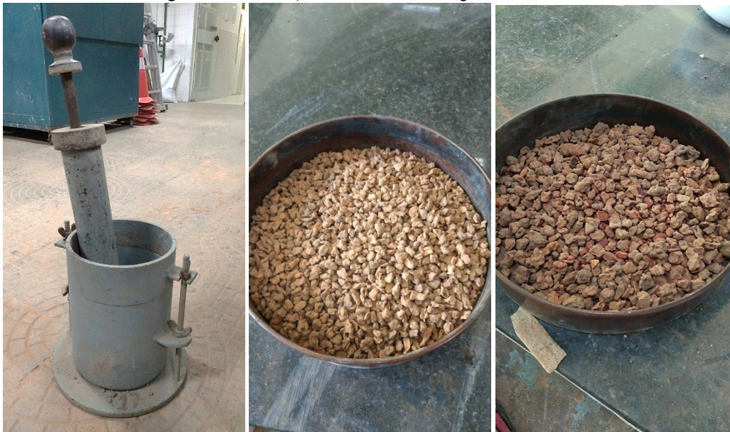
Figura 44: Execução do ensaio de fragmentabilidade
