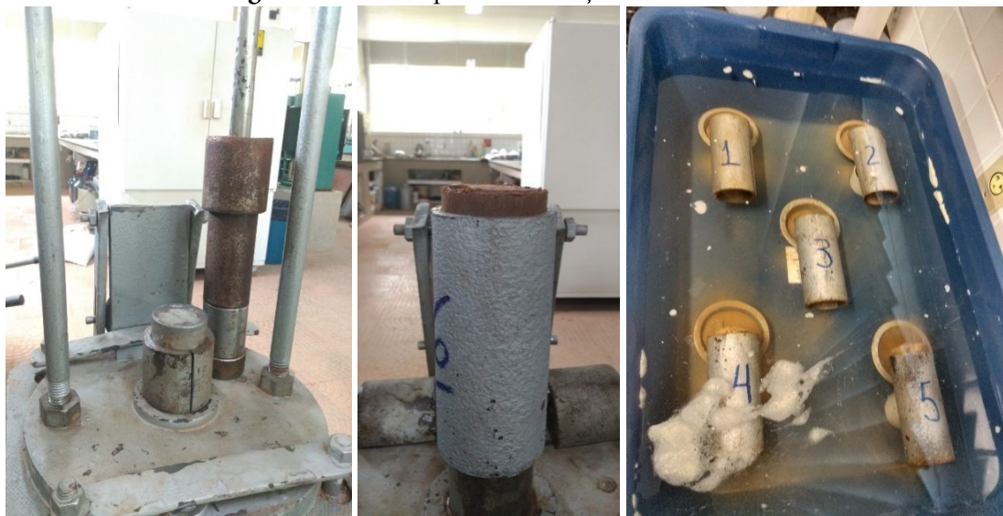
Figura 32: Ensaio para classificação MCT e G-MCT
