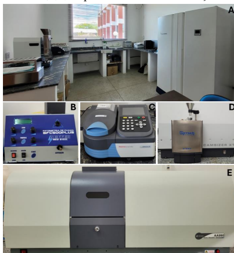
Figura 3 - (A) Labsol; (B) Fotômetro de chama; (C) Espectrofotômetro UV-VIS; (D) Camsizer; (E) Espectrofotômetro de absorção atômica
