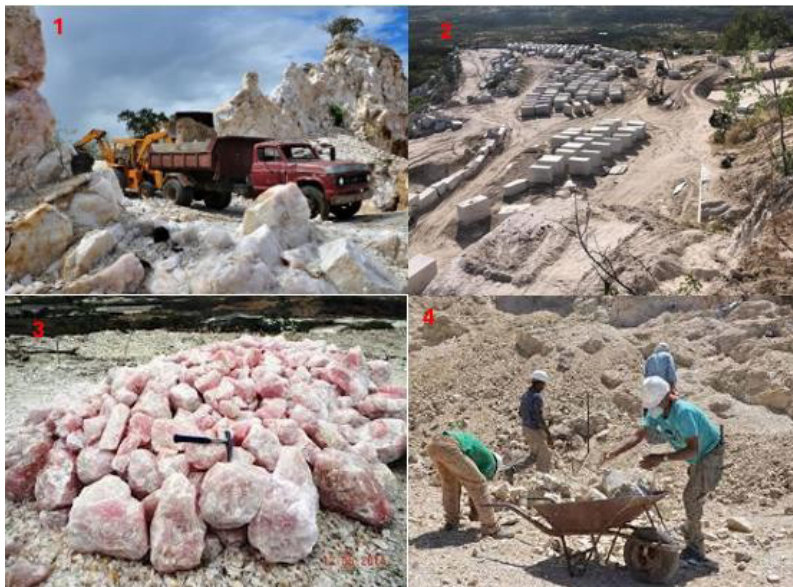
Figura 1 – Aspectos gerais do processo do aproveitamento dos pegmatitos na PPB: extração e carregamento nas minas (1), pátio de estocagem de blocos de pegmatito (2), pilha de mineral de quartzo rosa pré-selecionado (3) atividade garimpeira manual (4).
