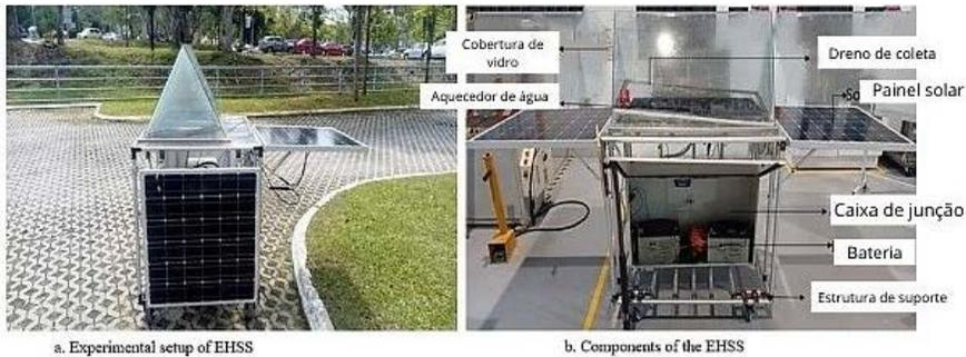
Figura 2. Estrutura do dessalinizador solar ativo na Malásia. Fonte: Isah *et al.* (2024)
