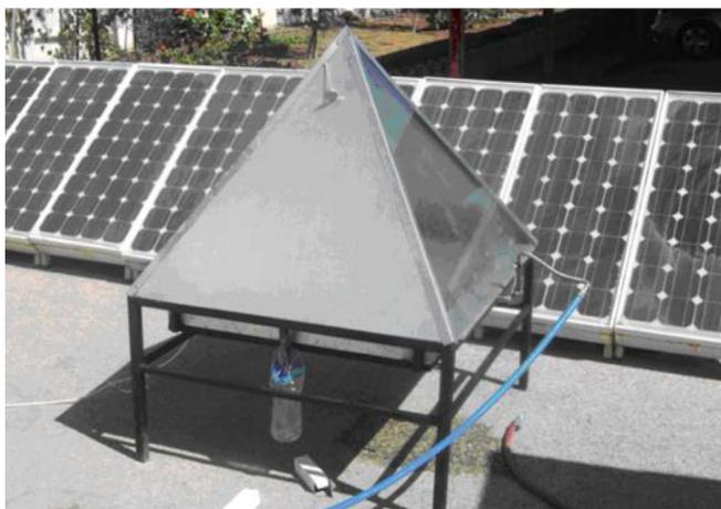
Figura 3. Estrutura do dessalinizador solar ativo na Jordânia. Fonte: Bandran *et al.* (2023)
