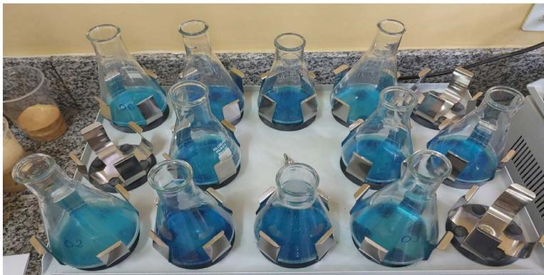
Figura 7 - Erlenmeyers contendo 25 mL da solução de corante, na mesa agitadora.
