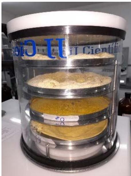
Figura 1: Secagem por método de liofilização. Fonte: Autor (2024).
