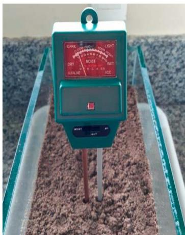
Figura 5 - Medidor 3x1 acoplado ao biorreator com solo contaminado com a carga. Fonte: Própria autoria (2018).
