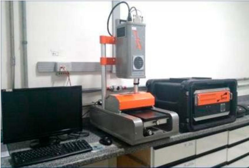
Figura 5: Espectrômetro de Imagens Hiperespectrais - HSI-NIR
