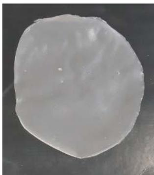
Figura 3 – Membrana de amido de Jaca com PVA
