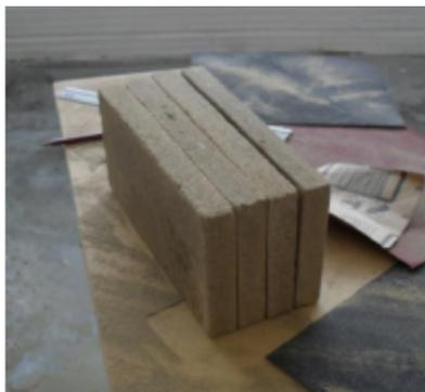
**Figura 114** – Placas com material em proporção ideal
