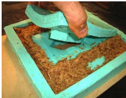
**Figura 53** – Fixação das peças em resina acrílica na matriz de MDF e inserção da fibra natural no molde do porta-retratos
