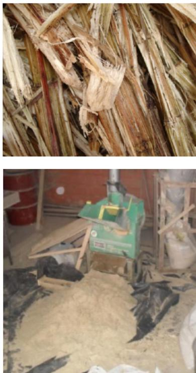
**Figura 118** – Processamento do bagaço de cana ainda úmido
