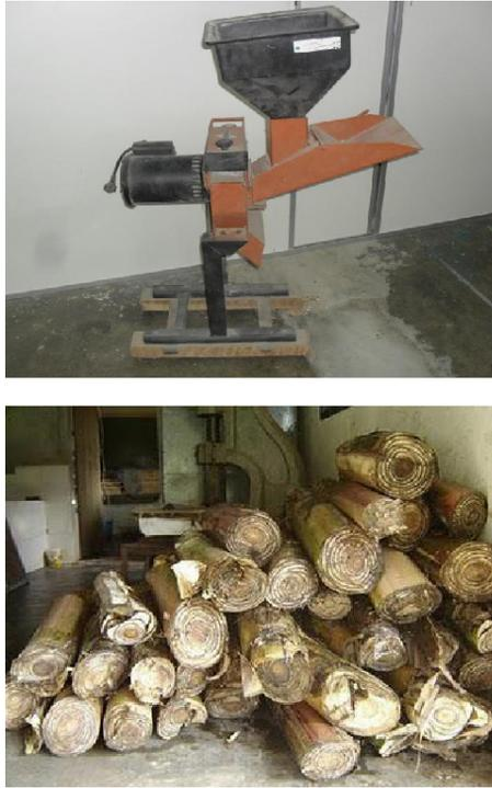
**Figura 103** – Máquina forrageira e troncos de bananeira
