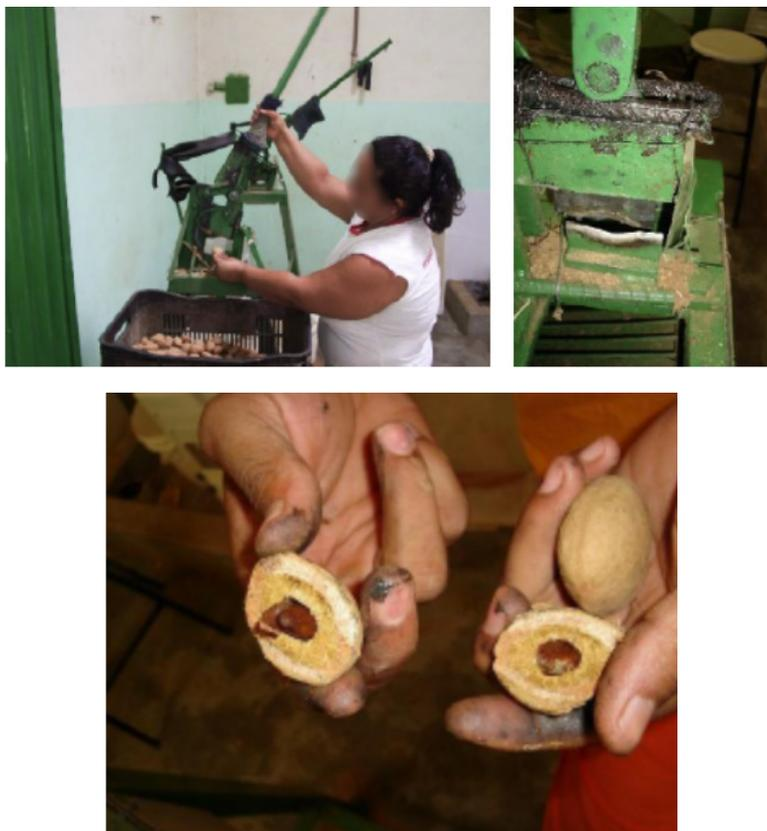
**Figura 79** – Equipamentos com lâminas para cortar o fruto
