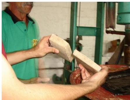
**Figura 106** – Placas compactadas na prensa industrial e moldes de aço de tamanhos variados
