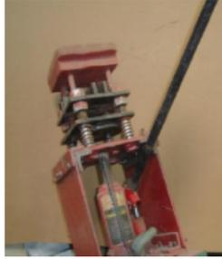
**Figura 86** – Posicionamento provisório da alavanca de força
