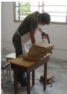
**Figura 117** – Trabalhando com as placas de bagaço com máquina e manualmente
