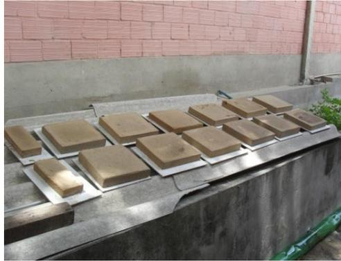
**Figura 113** – Placas secando ao sol
