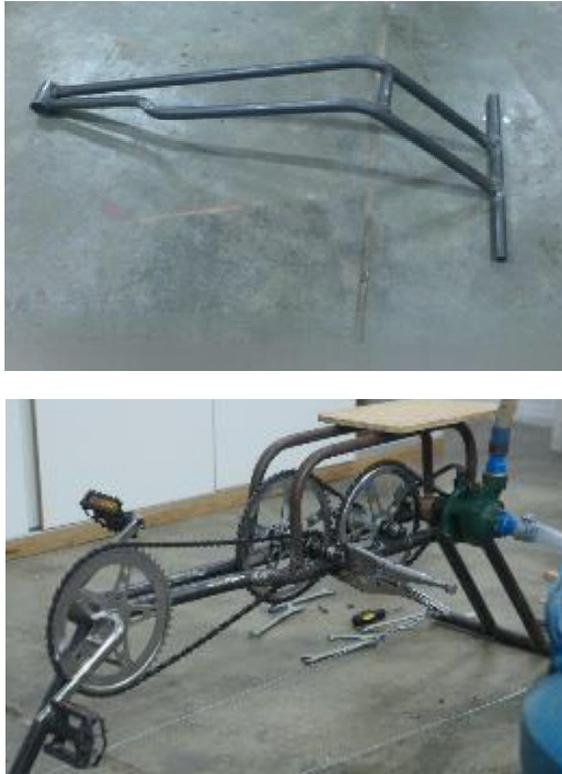
**Figura 34** – Protótipo da segunda estrutura: eixo principal e chassi completo com sistema de transmissão
