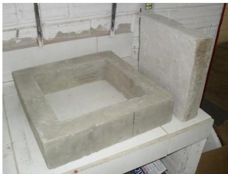
**Figura 109** – Concreto despejado no molde e molde de concreto armado
