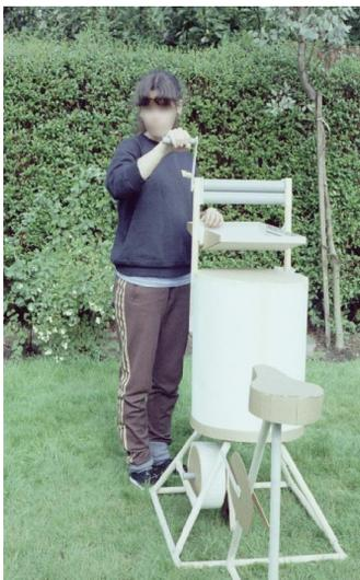
**Figura 10** – Modelo para determinar as dimensões da máquina
