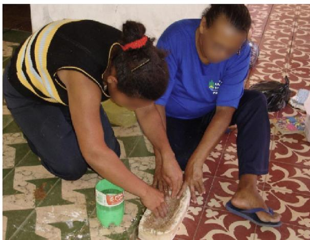
**Figura 55** – Modelagem de peça com fibra de bananeira
