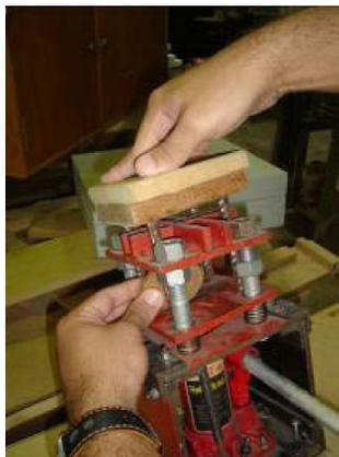
**Figura 85** – Inserção e posicionamento do baru nas mandíbulas do sistema
