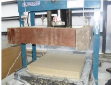
**Figura 112** – Prensa de 10 toneladas e primeira prensagem (aplicação de 02 toneladas)
