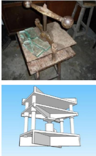
**Figura 111** – Prensa de encadernador e prensa desenvolvida para o projeto
