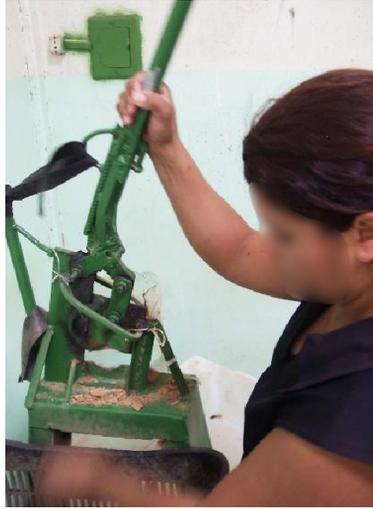
**Figura 81** – Alavanca de acionamento do instrumento de corte
