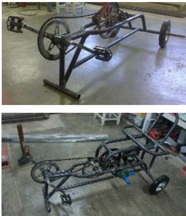
**Figura 35** – Protótipo da terceira estrutura: vista lateral e superior
