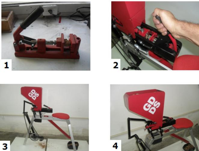
**Figura 96** – Versão final da máquina decortadora de baru
