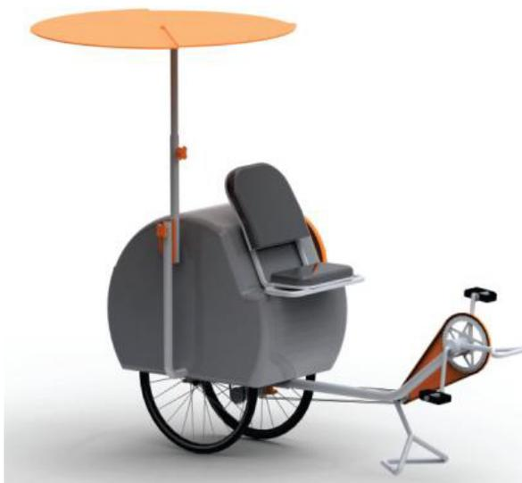
**Figura 31** – Conceito da unidade de bombeamento de água movida à propulsão humana
