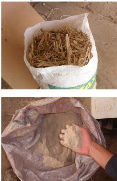
**Figura 110** – Bagaço de cana e bagaço transformado em pó
