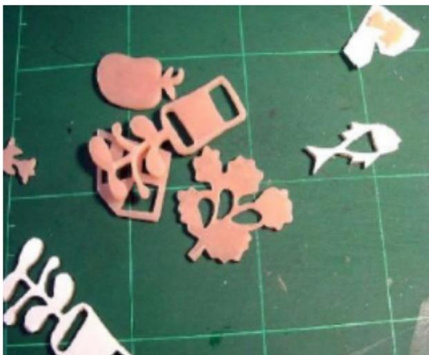
**Figura 52** – Moldes em alginato para a fundição da resina acrílica
