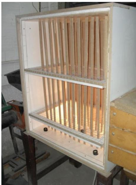
**Figura 116** – Estufa vertical com capacidade para 36 placas
