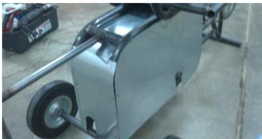
**Figura 44** – Carenagem em chapa galvanizada 26
