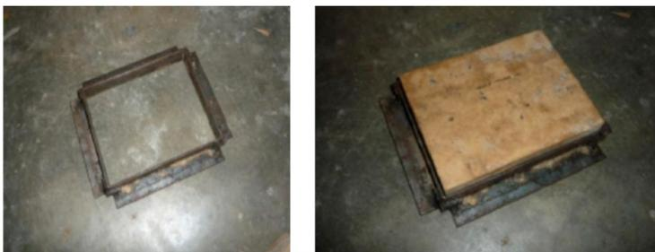
**Figura 105** – Molde de aço e molde de aço com tampo de madeira
