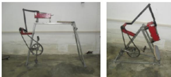
**Figura 95** – Adaptação de pedais na segunda versão em substituição à alavanca
