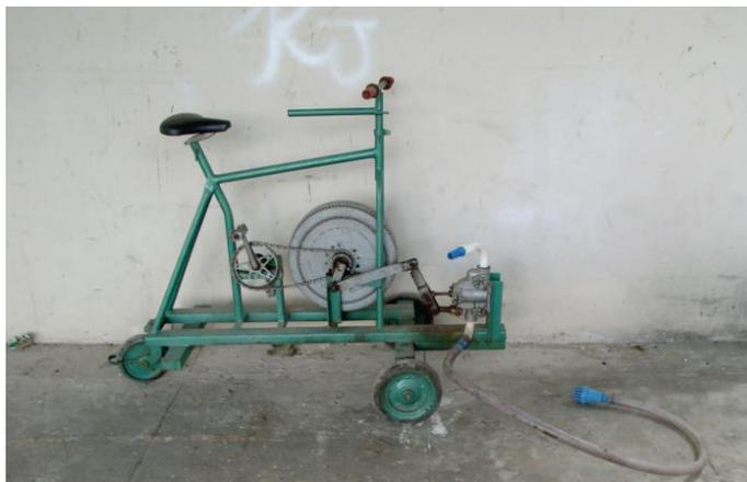
**Figura 26** – Bomba com sistema mecânico de bicicleta
