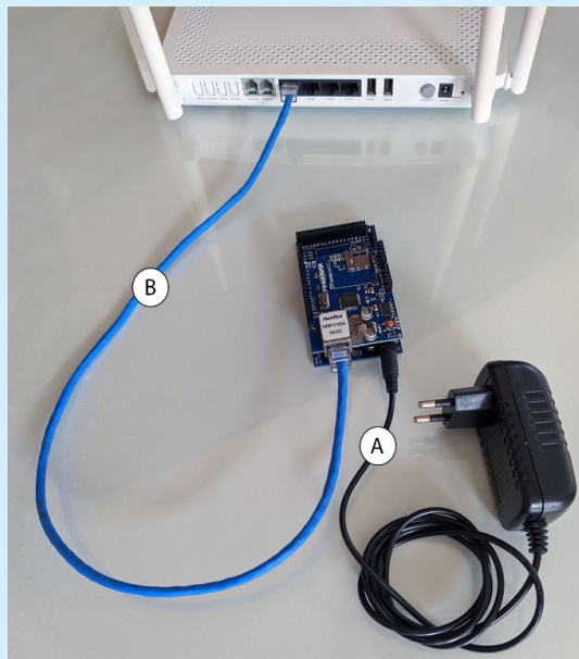
Figura 5 - Conexão placa Arduino à rede de energia (A) e conexão módulo Ethernet ao roteador (B)
