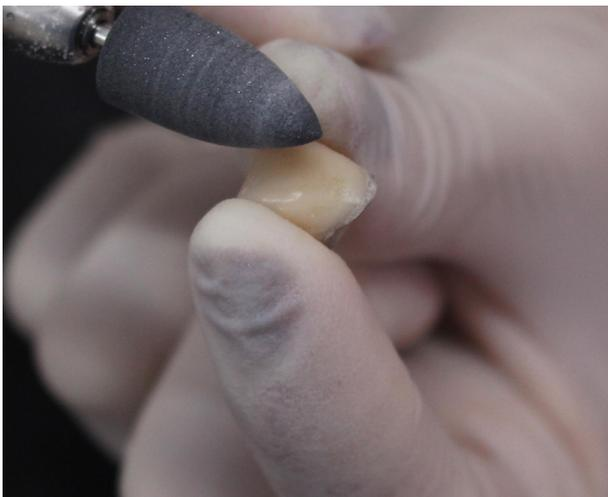
**15** | Acabamento utilizando pontas de borracha abrasivas
