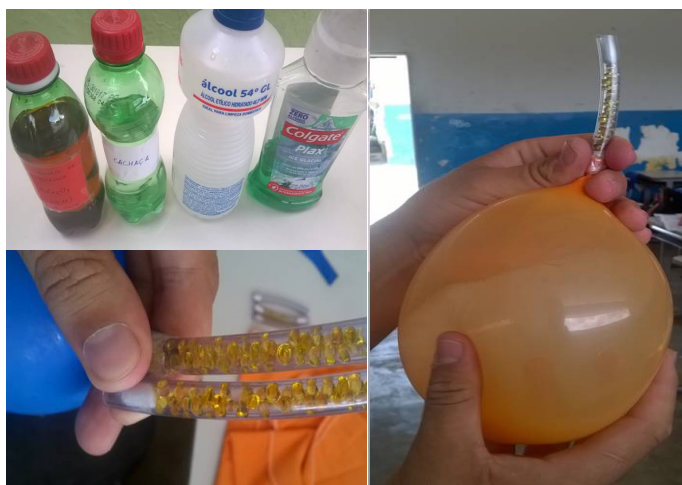
Figura 1 - Atividade experimental utilizando bafômetro alternativo de dicromato de potássio
