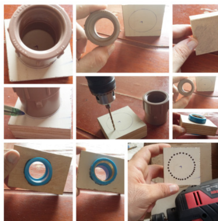
Figura 4 – Encaixe de luva metálica
