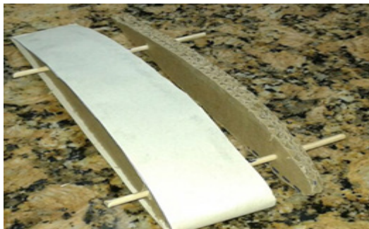
Figura 6 - Nervuras de papelão
