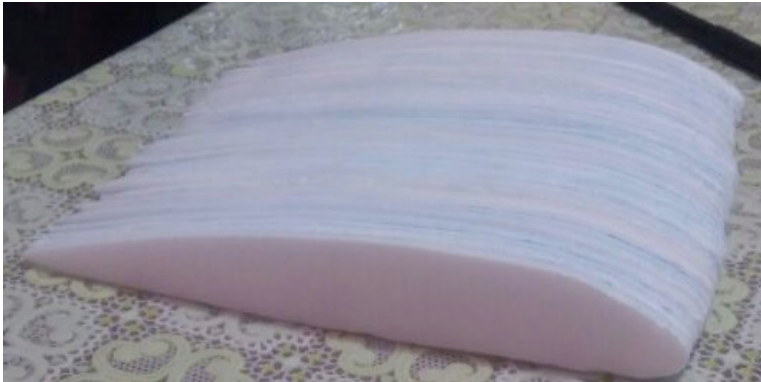
Figura 7 - Protótipo de DEPRON Maciço
