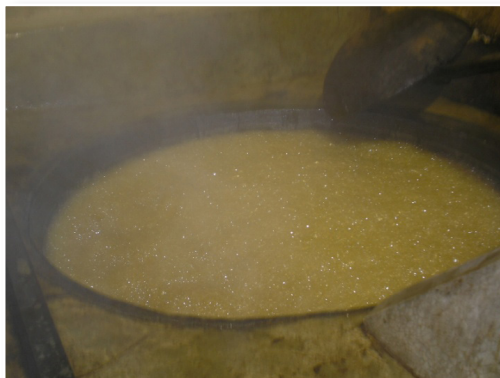
FIGURA 48 – CALDO NO PROCESSO DE APURAÇÃO
