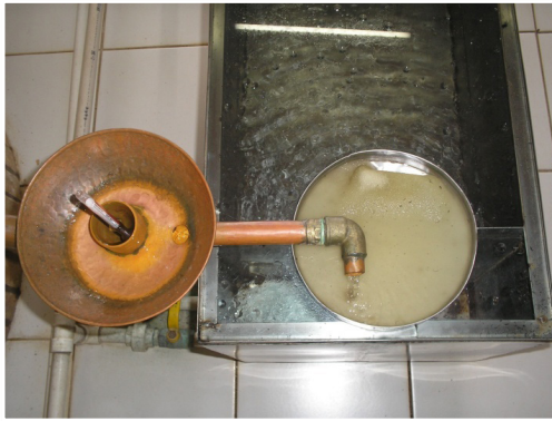
FIGURA 37 – ALAMBIQUES - SEPARAÇÃO: CABEÇA, CORAÇÃO E CALDA.
