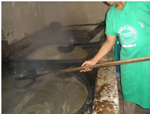
Cozimento do caldo em três tachos.
