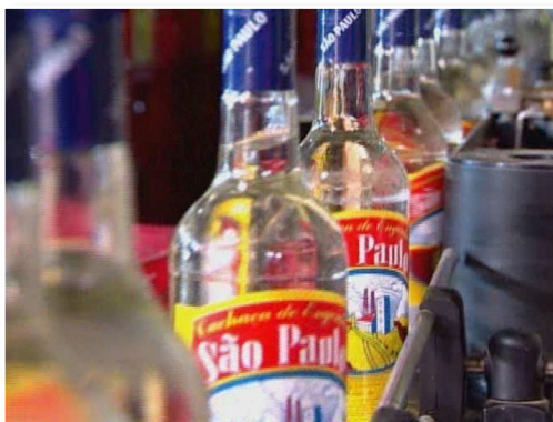
Garrafa final: garrafa cheia, rótulo, lacre ou tampa. Falta apenas o selo relativo à tributação.
