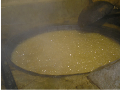
FIGURA 47 – TACHO DE COZIMENTO, “O APURADOR”
