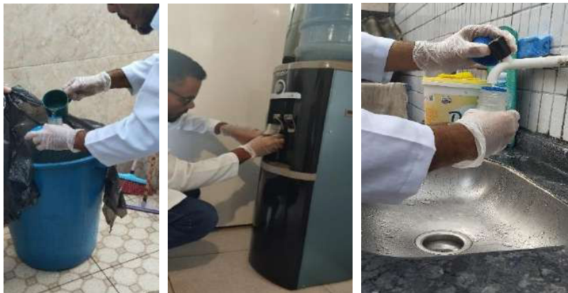
Figura 2 - Coleta de amostra de água em diversos pontos na escola: balde de armazenamento, bebedouro e pia Fonte: Os autores.
