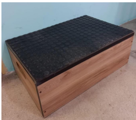
Figura 1 - Degrau utilizado para a execução do teste
