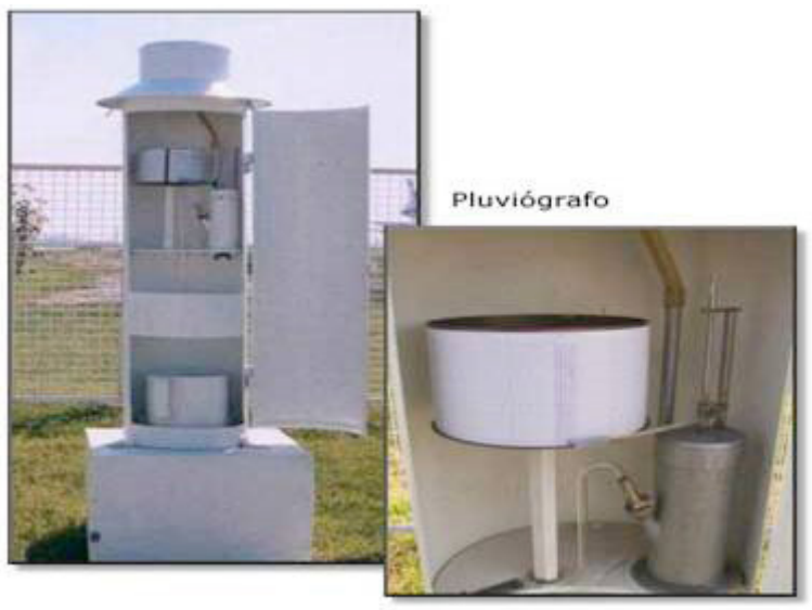
Figura 80 - Pluviôgrafo e detalhe da cisterna e do registrador
