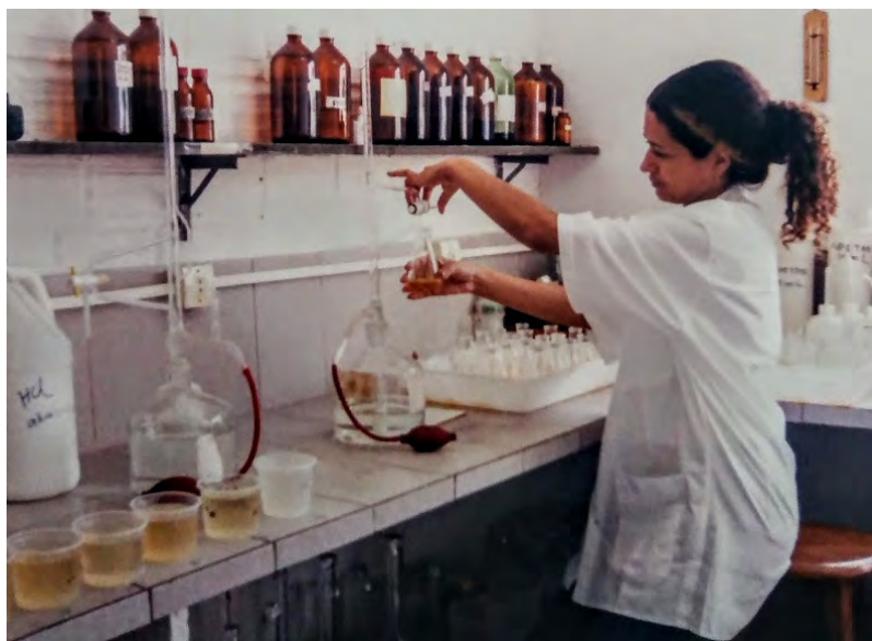
Figura 6 – Água residuária para análise química, em que se detectou a presença de muitos elementos químicos, inclusive, fósforo, nitrogênio e matéria orgânica. UFCG/PROSAB, Campina Grande-PB, 2004 Fonte: Autoria própria.
