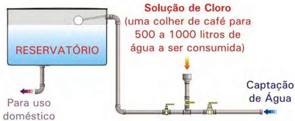
Figura 6 – Clorador seguido do reservatório de água tratada Fonte: Embrapa (2014).
